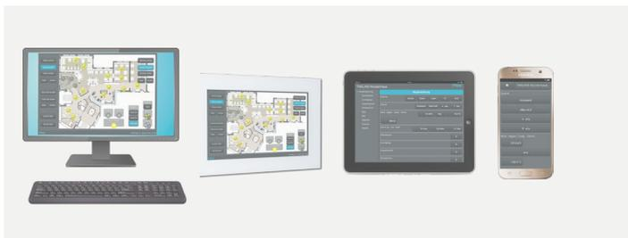
Einbaupanels und PC sind ortsfeste Verbindungen über das Gebäudenetzwerk, mit Notebook, Tablet und Smartphone wird ortsunabhängig über W-LAN bedient. Zusätzlich können Fernbedienungen auf Funkbasis eingesetzt werden. Die Funkstrecke basiert auf der batterielosen EnOcean Technologie. Die Möglichkeiten umfassen ein breites Spektrum an Funksensoren (stationäre fix montierte Funktaster, Handfernbedienungen und Funkthermostaten), sowie eine Auswahl an Funkaktoren.
